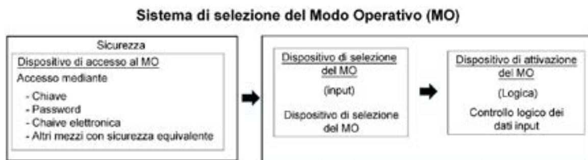
Figura 4: Relazione fra security e safety in sistema di abilitazione modale di macchina (figura 1 della UNI EN ISO 16090-1:2023)
