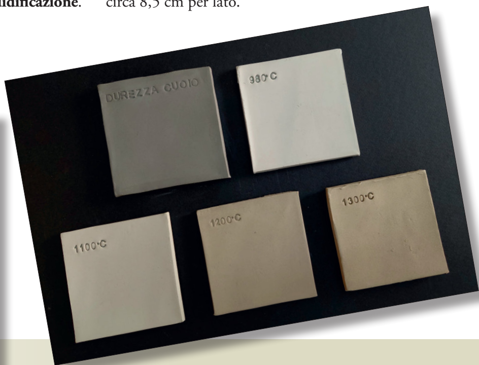
Provini preparati dallo stesso impasto e con le medesime dimensioni (10 × 10 cm) e portati a temperature differenti per mostrare la variazione dimensionale. La porzione marchiata "durezza cuoio" può essere usata a riferimento; la specifica dicitura intende infatti una fase consolidata ma ancora a crudo.
