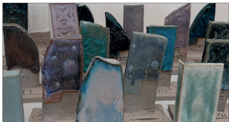
Prove colore con gli smalti. Dato che l'aspetto post cottura può variare in base a molteplici fattori, vengono sempre fatte delle prove preliminari su pezzi lasciati piuttosto grezzi.
