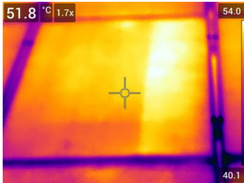
Figura 1- Modulo fotovoltaico con diodo di bypass non funzionante.
