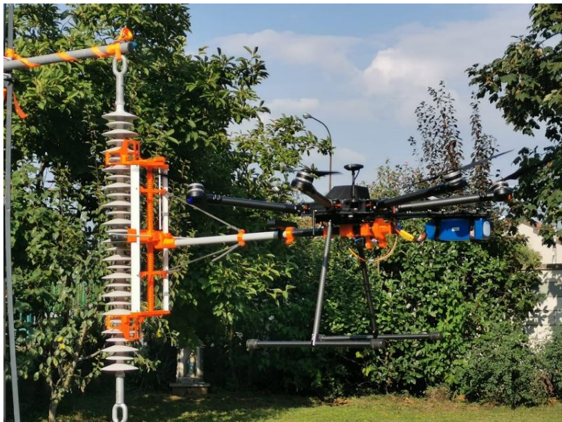
Figura 7: Sistema ARIES durante una dimostrazione di ispezione a contatto contro mock-up di isolatore.
