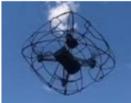
Figura 2. Drone resistente alle collisioni
