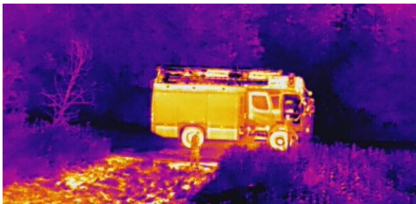
Figura 5: Ripresa termografica di un terreno con sversamento
