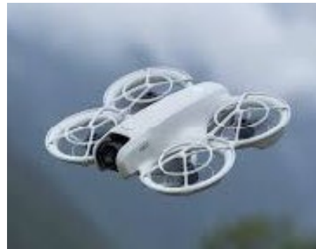
Figura 2. Drone resistente alle collisioni
