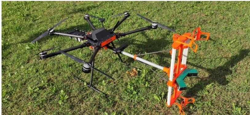
Figura 6: Sistema ARIES nella configurazione con payload per ispezione di isolatori.
