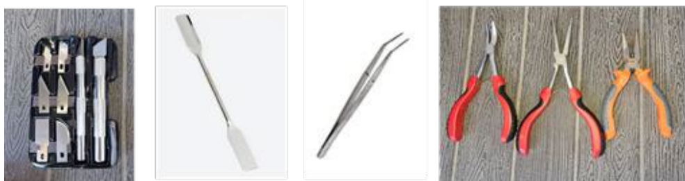
Figure 38 - esempio di utensili per il prelievo di campioni friabili
