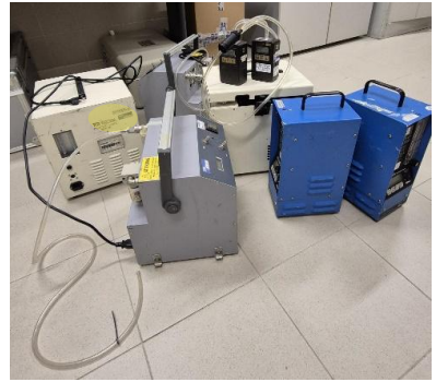
Figura 46 - pompe di campionamento per alti e bassi flussi
