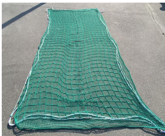
Figura 6.4.2.1.2-13 Rete in polipropilene invecchiata doppio strato maglia 100x100 mm più maglia 20x20 – Fine prova Particolare
