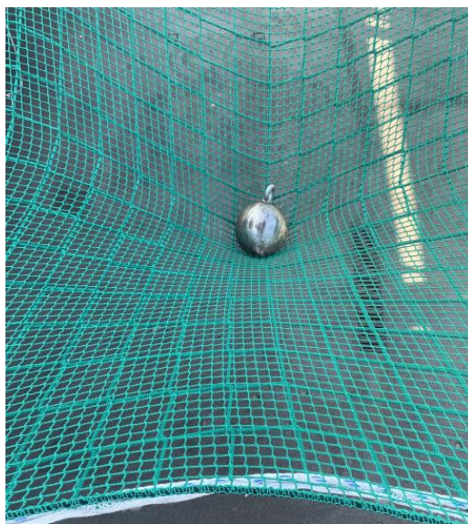
Figura 6.4.2.1.2-11 Rete in polipropilene invecchiata doppio strato maglia 100x100 mm più maglia 20x20 – Fine prova
