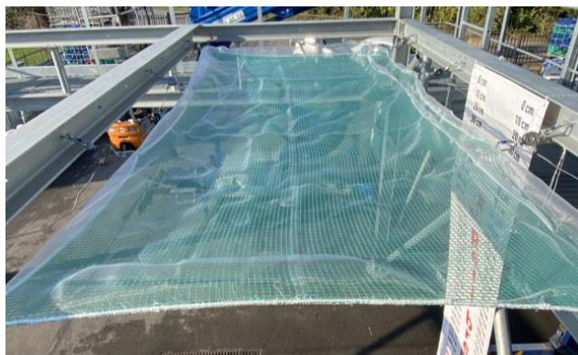
Figura 6.4.2.1.1-20 Rete nuova singolo strato con telino - polipropilene, maglia 20 x 20 (mm) – Inizio prova
