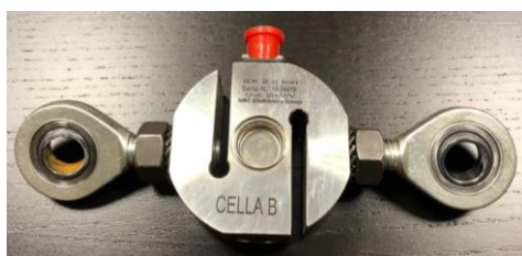
Figura 6.2.2.3-1 Cella di carico
