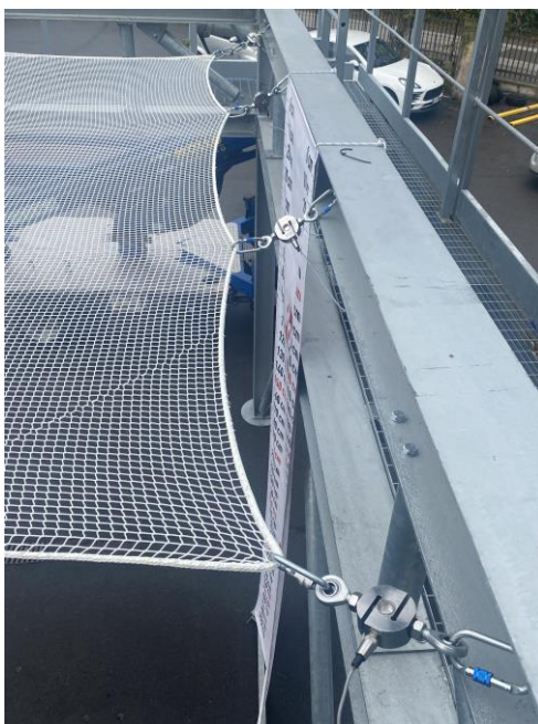
Figura 6.2.2.4-1 Attrezzatura di prova, celle di carico e nastro graduato
