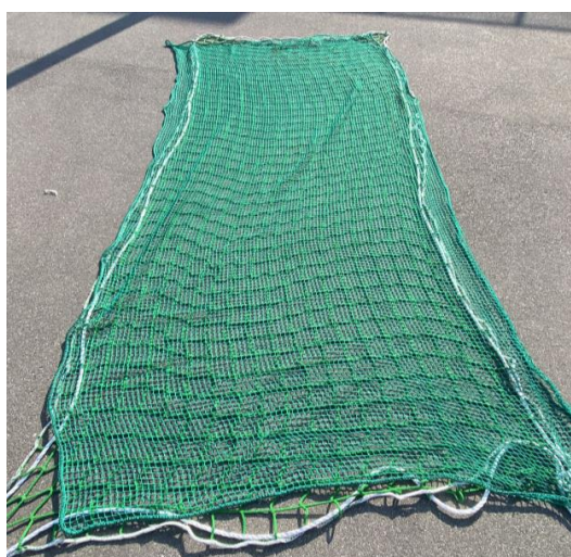
Figura 6.4.2.1.1-22 Rete in polipropilene nuova doppio strato maglia 100x100 mm più maglia 20x20 – Fine prova
