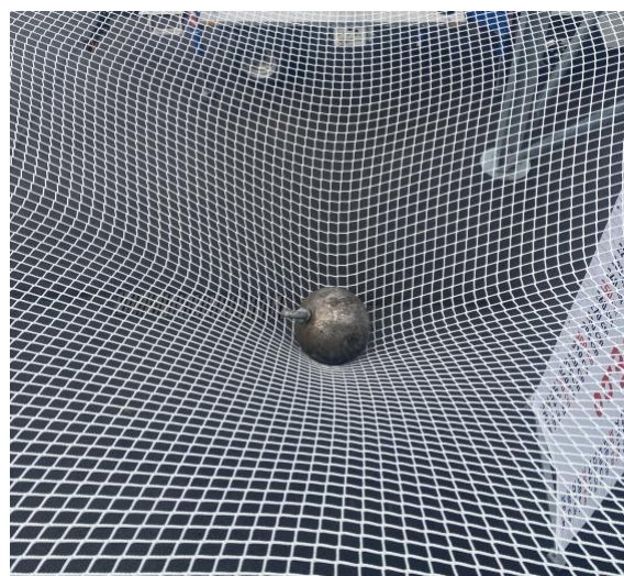
Figura 6.4.2.1.1-18 Rete nuova singolo strato senza telino - poliammide, maglia 20 x 20 (mm) – Fine prova
