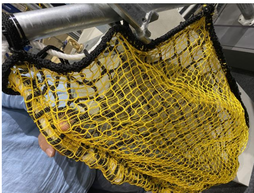
Figura 4.4-4 - Safety net fan (Doka)
