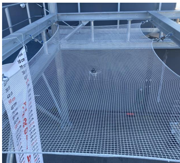
Figura 6.4.2.1.2-9 Rete invecchiata singolo strato senza telino - poliammide, maglia 20 x 20 (mm) – Fine prova Rottura mediante sfera
