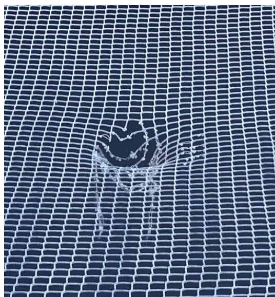
Figura 6.4.2.1.2-10 Rete invecchiata singolo strato senza telino - poliammide, maglia 20 x 20 (mm) – Fine prova Rottura mediante sfera – Particolare
