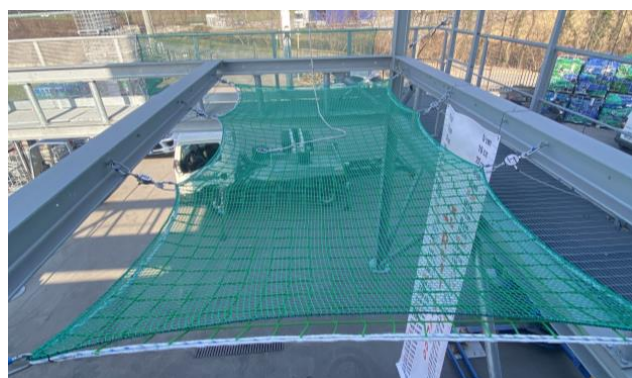
Figura 6.4.2.1.1-21 Rete in polipropilene nuova doppio strato maglia 100x100 mm più maglia 20x20 – Inizio prova
