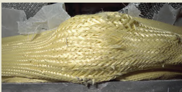
Sopra: Prova impatto balistico su kevlar® (fibra para-aramidica) intrecciato, NASA/Glenn Research Center. A fianco: Fibra di kevlar®.
